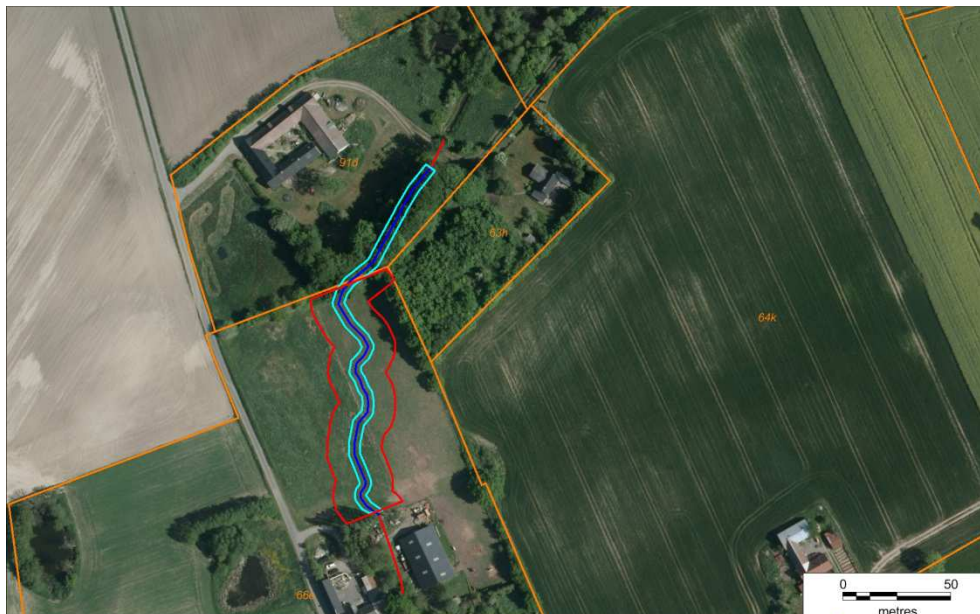
Figur 16 Samsingså nedre vist med 10 m randzone uden om en 5,3 m bred udgravning
