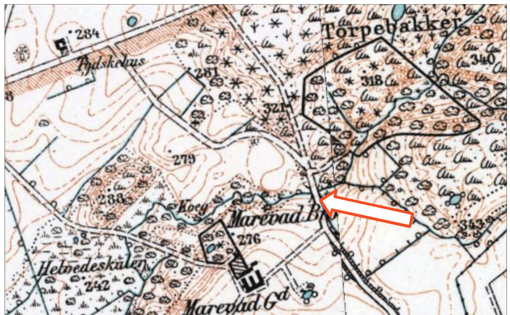
Figur 2 Marevad Bro (lave målebordsblad). Det åbne forløb af den nu rørlagte strækning var dengang kun svagt slynget. Pilen viser begyndelsen af den nu rørlagte strækning.
